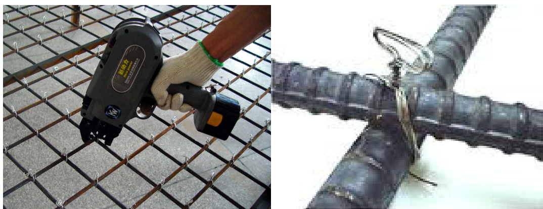
Figur 2.6 Exempel på najning med handhållen najmaskin
