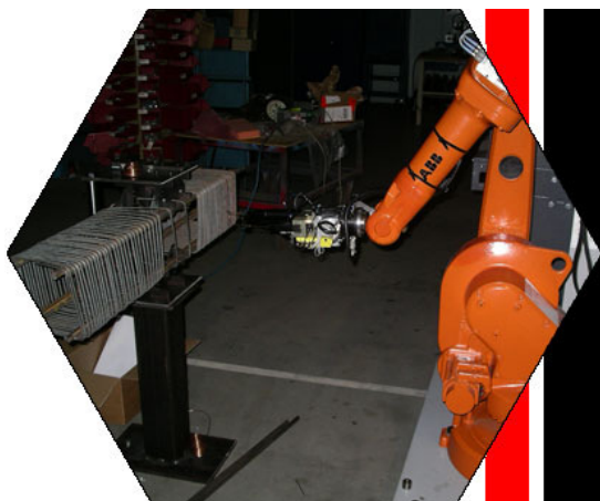
Figur 2.10 Exempel på najrobot för tillverkning av armeringskorgar ( http://www.arho.se )
